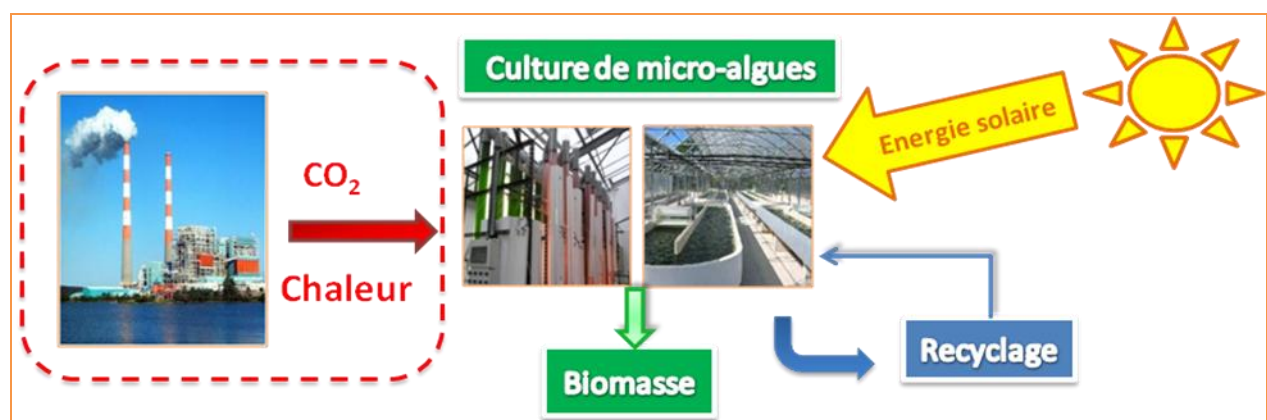
Figure 1 : Schéma général d'un système de production de microalgues à partir de fumées industrielles.
