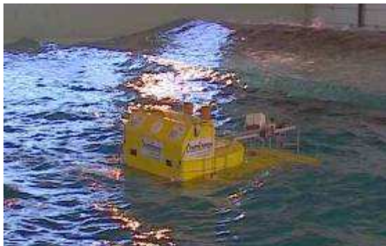
Système de récupération de l'énergie de la houle en test dans le bassin océanique de l'ECN
