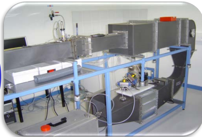
Pilote aérosols à flux traversant en régime continu one-pass
