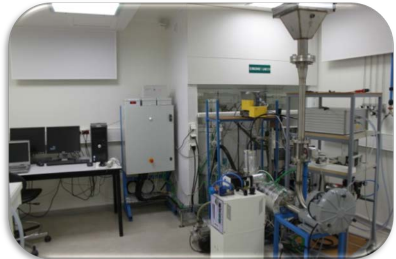
Pilote de traitement filtre à manche opérant jusqu'à 150°C
